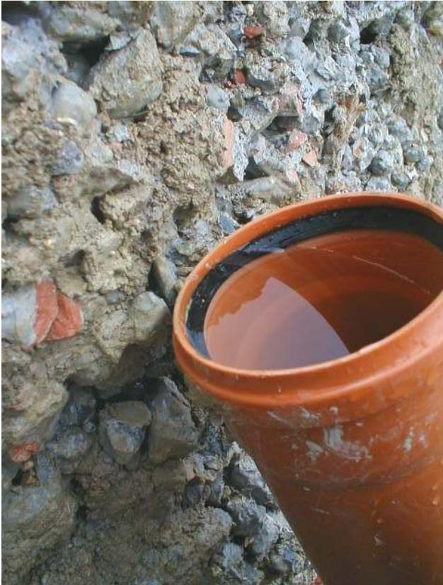
Bis zum Überlaufen auffüllen, damit eine genaue Dichtheitskontrolle abgenommen werden kann.
