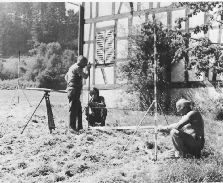
Orthogonale Aufnahmemethode. Mit dem Winkelstock wurden die Lotfusspunkte der einzumessenden Objekte auf der Polygonlinie bestimmt und die Distanzen mit hölzernen 5-m-Latten gemessen. Mit den Messwerten wurde im Feld der Handriss konstruiert.
