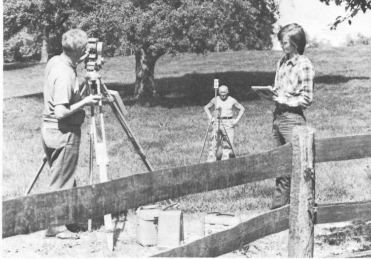
Elektrooptisches Distanzmessgerät im Einsatz
