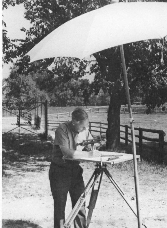
Topographische Geländeaufnahme mit dem Messtisch. Die Dufour- und Siegfriedkarten, sowie auch die Katastervermessung Horgen aus dem Jahre 1866 wurden mit dem Messtisch aufgenommen.
