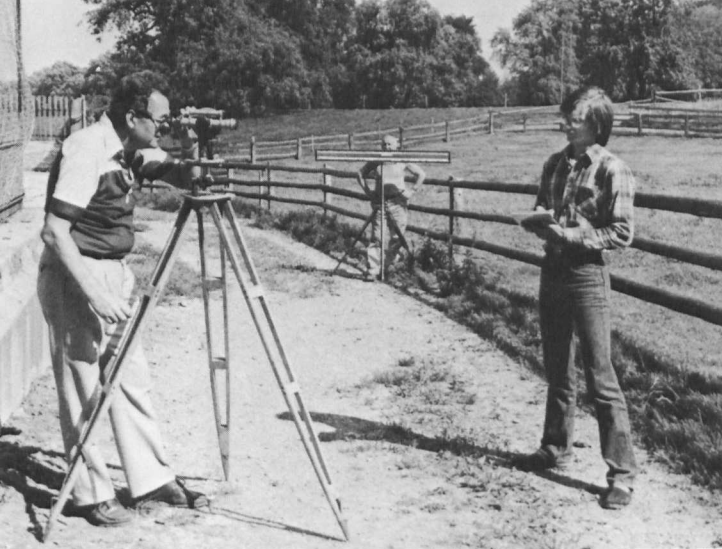
Polaraufnahme eines Grenzpunktes mit dem «Bergwerktheodoliten» und der «Werffelplatte». In den zwanziger Jahren begann mit diesen Messgeräten die Ära der optischen Distanzmessung.
