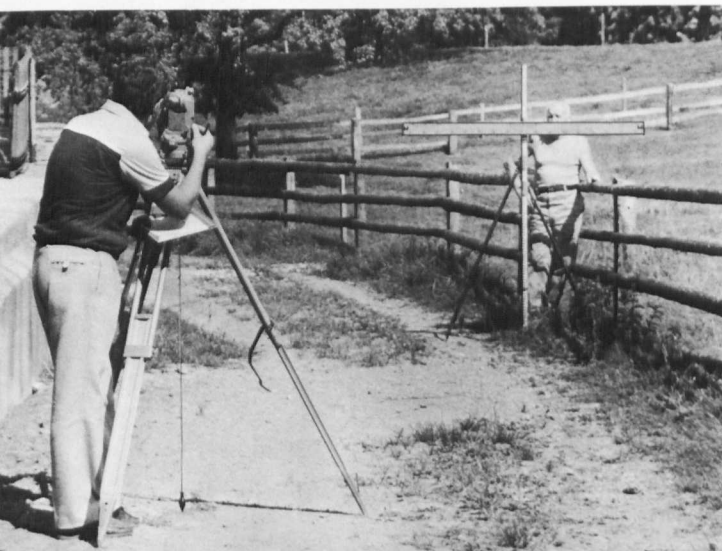
Polare Aufnahme mit dem damals neuen Doppelbild-Tachymeter-Theodoliten Wild RDH. Dieses Gerät war während 1 1/2 Jahrzehnten vor allem für die Nachführung des Vermessungswerkes in dauerndem Einsatz. Es wurde 1979 durch einen Elektrooptischen Distanzmesser ersetzt. Seither bereichert es das «Gerätemuseum» des Bauamtes.
